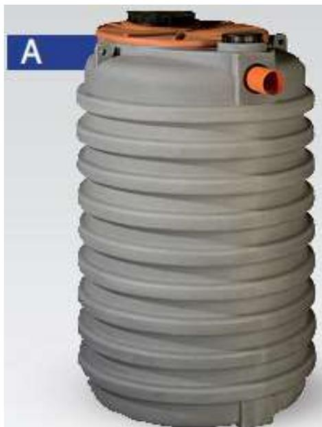
I degrassatori della Diliberato srl monoblocco di entrata e uscita con guarnizione in gomma e coperchio di ispezione e prelievo schiuma calcificante e materiali flottanti sono dimensionati per una capacità minima di 50 litri per A.E. E' previsto uno smorzatore turbolenze come da schema ARPA.
