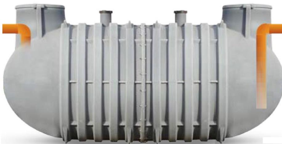
I degrassatori della Diliberato srl sono costituiti da un serbatoio monoblocco in polietilene rotostampato con tubazioni di entrata e uscita con guarnizione in gomma e coperchio di ispezione. Sono dimensionati per una capacità minima di 50 litri per A.E.
