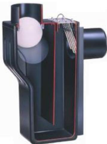
Unità multifunzionale di troppo pieno per serbatoi recupero acque piovane Prodotto in ABS resistente ad impatto. Per il montaggio all'interno di serbatoi svolge la funzione di "troppo pieno", scaricando l'acqua in eccesso. Rimuove i detriti di superficie fornendo un effetto filtrante. Previene la diffusione di odori, animali e sporcizia proveniente dai canali di scolo. Capacità: 6 litri.
