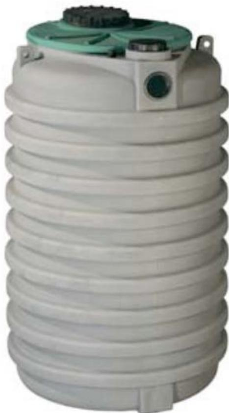
Realizzate in polietilene, le vasche Imhoff sono caratterizzate da un contenitore esterno corrugato in polietilene, un coperchio, un sedimentatore, un setto di separazione e tubi interni. Nel compartimento superiore delle vasche Imhoff avviene la sedimentazione primaria dei reflui, mentre nell'inferiore avviene la digestione dei fanghi.
