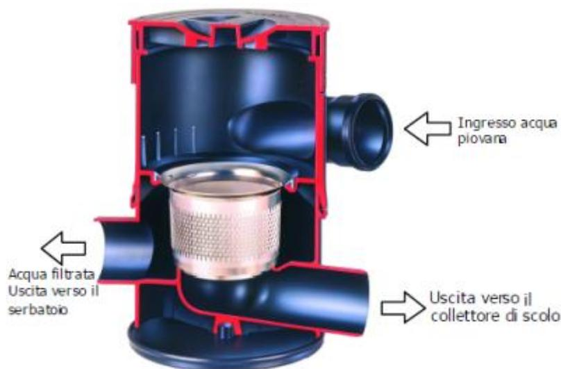
Filtro per acque piovane per installazione su tubazione orizzontale interrata o interna agli edifici civili o industriali. Alloggiamento in polipropilene, filtro in acciaio inossidabile, a manutenzione ridotta. Dimensione della griglia filtrante di 0.28mm o 0.44mm.
